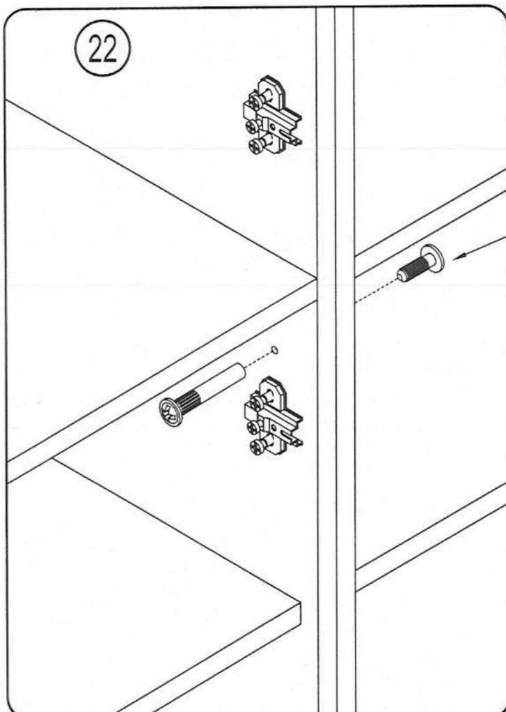
Для соединения шкафа FTF в композицию с соседними изделиями мебели, просверлите дополнительные отверстия  $\varnothing 5$  и соедините их при помощи стяжки межсекционной MVTON 2950.
